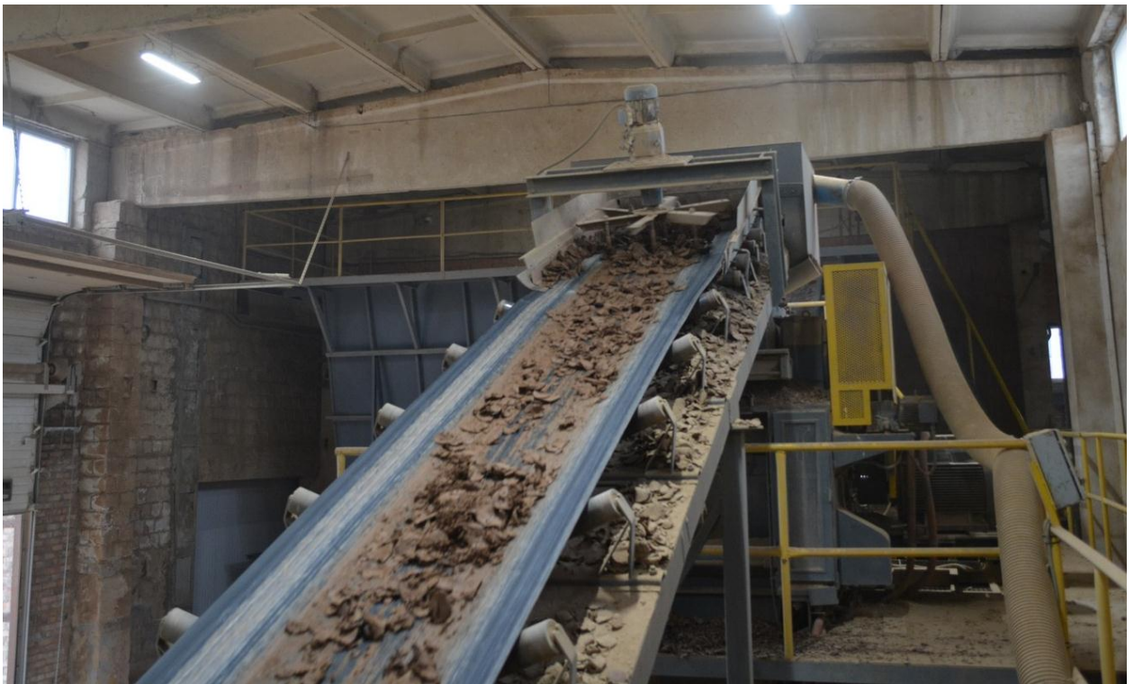
Рис. 2. Подача глины в бункер.
