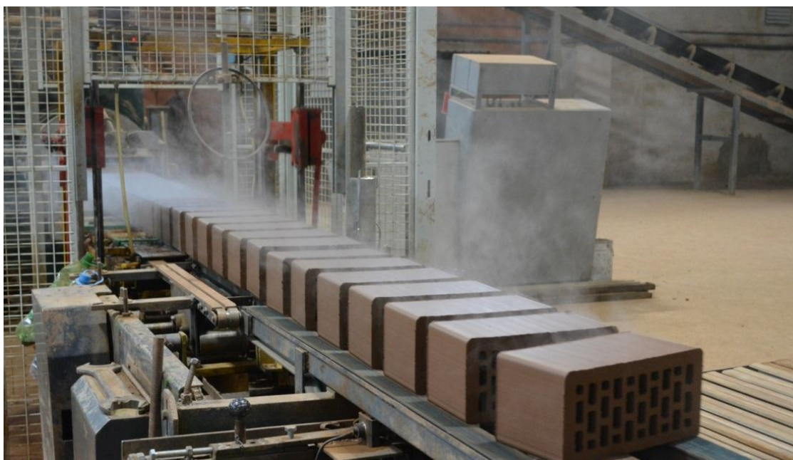
Рис.4. Работа резательного аппарата фирмы «Händle»
