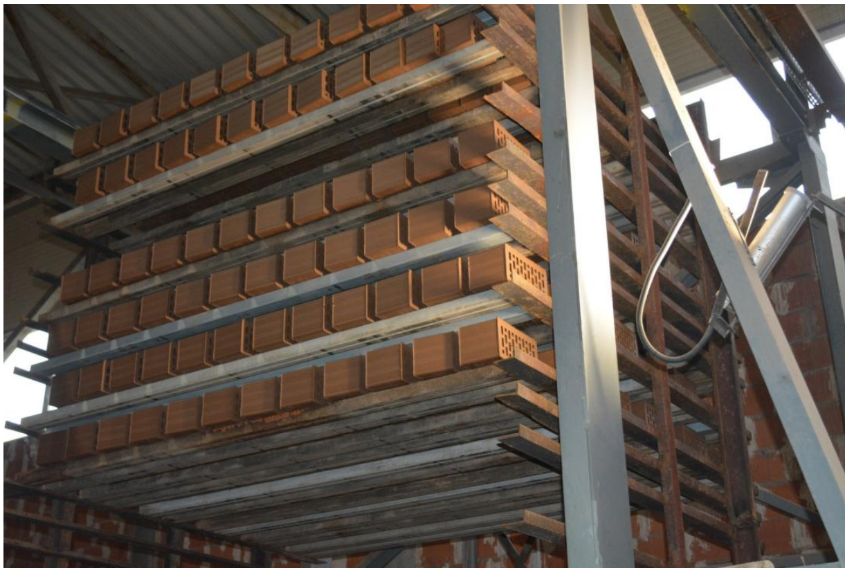
Рис.5 Подача кирпича на сушильный вагон
