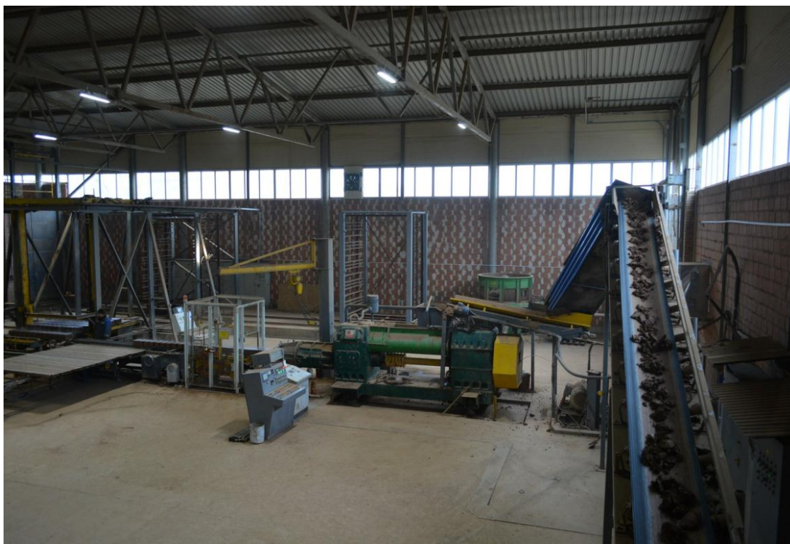
Рис.3. Готовая смесь поступает в формовочный пресс
